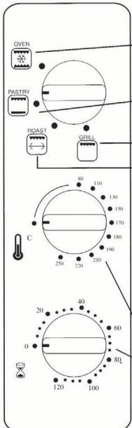
位置1. 烘焙功能：當功能選擇器切至此位置時，上下電熱管同時啟動。且由溫度控制器控制所需之溫度。
